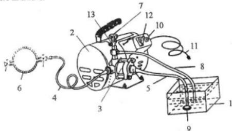
4.2. Принцип работы насоса заключается в том, что электронасосом осуществляется всасывание рабочей жидкости из бака 1 и подача её на испытываемый объект 6 (по нагнетательному трубопроводу 4).
